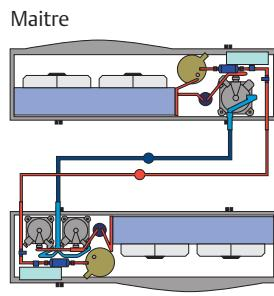
— Liquid line / Ligne liquide / Flüssigkeitsleitung
